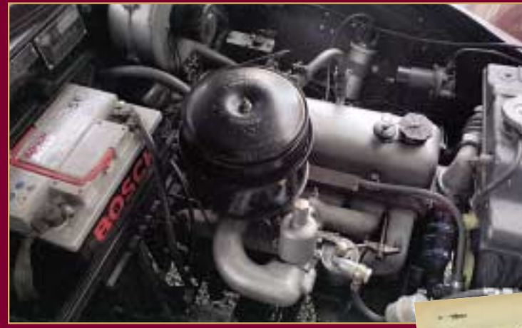
De 1250cc XPAW motor in de 4/44 was als XPAG ook te vinden in de MG Y, TC, TD en TF.
