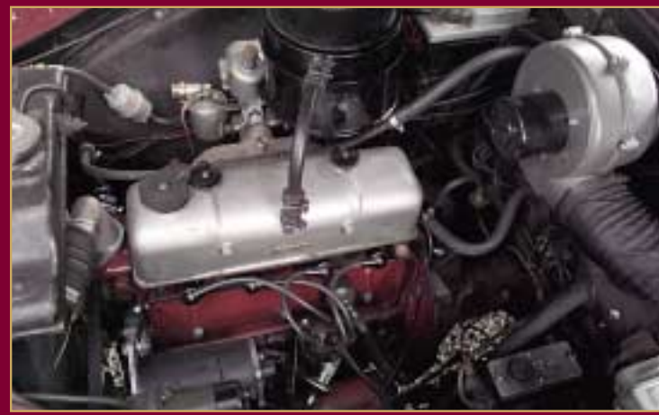
De 1250cc XPAW motor in de 4/44 was als XPAG ook te vinden in de MG Y, TC, TD en TF.
