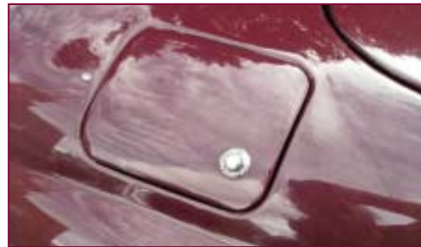
Tankklep kon vanuit de koffer worden vergrendeld tegen diefstal.
