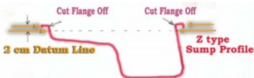
Fig. E1 Preparing MG ZA/ZB Sump
